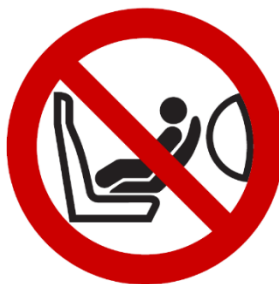
Hình 2 - Ký hiệu tượng hình theo ISO 2575:2004 - Z.01 được sử dụng cùng với hình tròn có đường kính ngoài nhỏ nhất 38 mm
