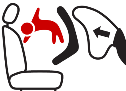
Hình 3 - Ký hiệu tượng hình thể hiện nguy cơ khi túi khí nổ có kích thước chiều rộng 40 mm, chiều cao 28 mm hoặc lớn hơn với cùng tỉ lệ
